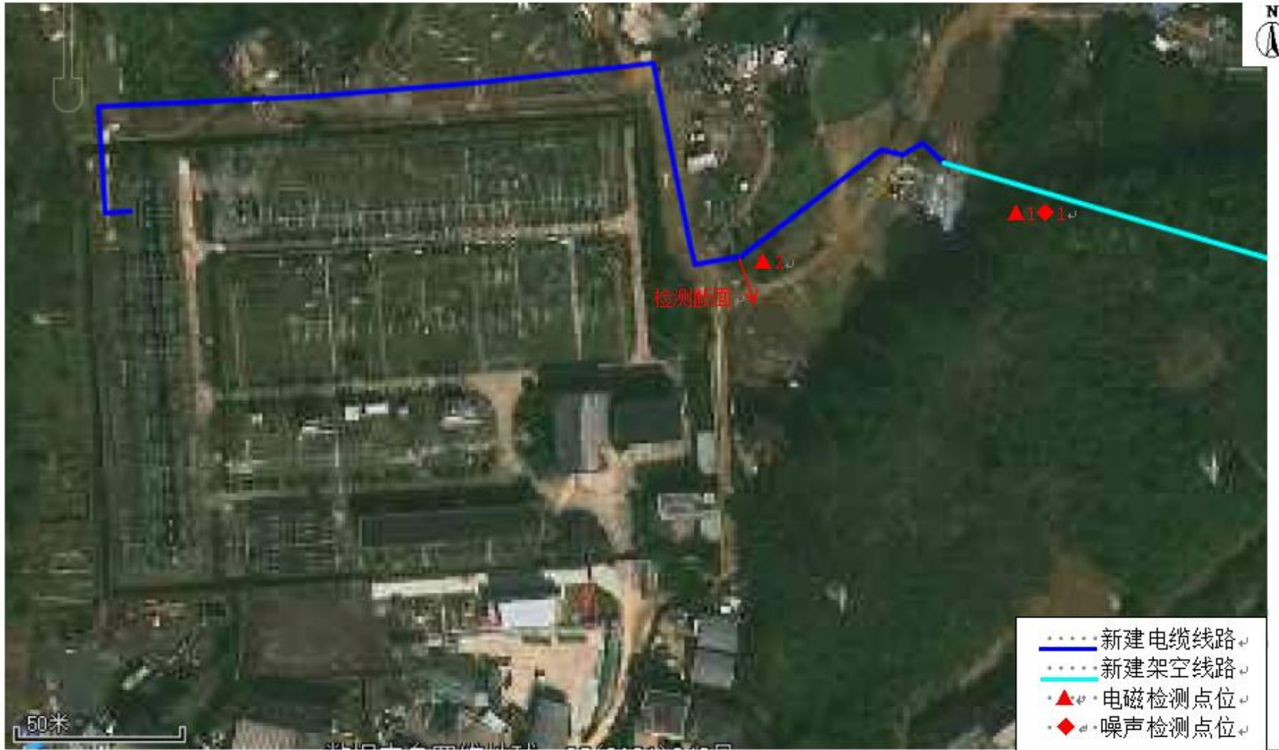
图 7-1 杭州临安区锦城 110 千伏变电站迁建配套线路工程工频场强及噪声检测点位示意图 (1)
